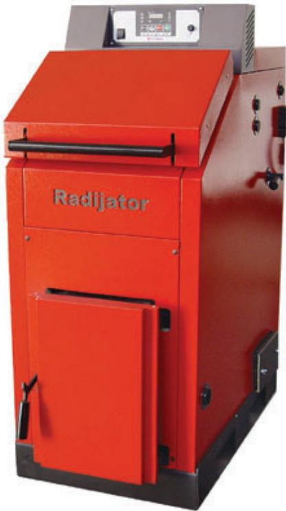
Според надворешниот изглед, котлите од оваа серија наликуваат на трајножаречките котли од серија K. Меѓутоа, постои суштинска разлика помеѓу овие две конструкции, бидејќи кај FK изменувачките површини се така поставени, што овој котел има ложиште со т.н. горно согорување. Вентилаторот е сместен на задната страна, но преку посебни канали воздухот се пренесува напред под ложиштето.
